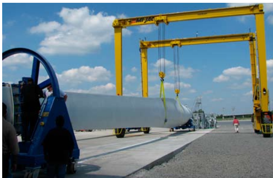
La grúa pórtico amarilla de Little Rock puede manipular nuestras mayores palas. La foto muestra el traslado de la primera LM 43.8 fabricada en Little Rock a la zona de almacenamiento.
