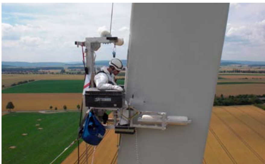
Billede af SkyChair-prototypen, der testes på en vindmølle i Tyskland. De sidste justeringer blev foretaget på baggrund af forslag til tekniske ændringer fra de serviceteknikere, der anvender udstyret.
