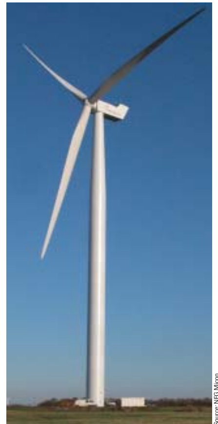
Las LM 54.0 P giran en un aerogenerador de prueba de NEG Micon de 4,2 MW.
