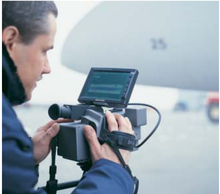
LM Glasfiber utiliza la tecnología termosensible para el control de calidad de las palas.
