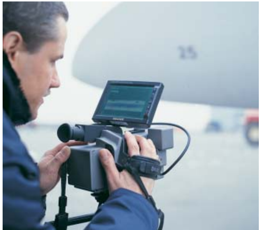
LM Glasfiber setzt wärmeempfindliche Technologie zur Qualitätssicherung der Rotorblätter ein.
