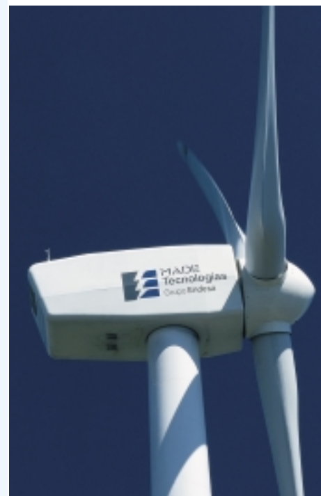
Die neuen Rotorblatttypen LM 27.1 P und LM 28.6 P wurden für den WEA-Hersteller MADE weiterentwickelt.
